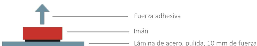
En el uso práctico, la fuerza adhesiva se reduce inmensamente por diferentes factores, por ejemplo la composición del producto (filmína suave comparada con papel duro) o por la composición y fuerza del tablero que se esté utilizando.
