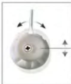
**Suspensión única:** alineación horizontal precisa, usando elementos excéntricos durante el montaje.
