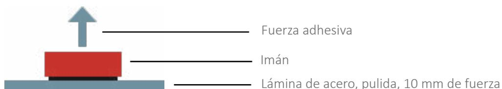
En el uso práctico, la fuerza adhesiva se reduce inmensamente por diferentes factores, por ejemplo la composición del producto (filmína suave comparada con papel duro) o por la composición y fuerza del tablero que se esté utilizando.
