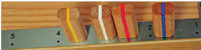
Piedras para la escala: para marcar el valor deseado en la escala.
